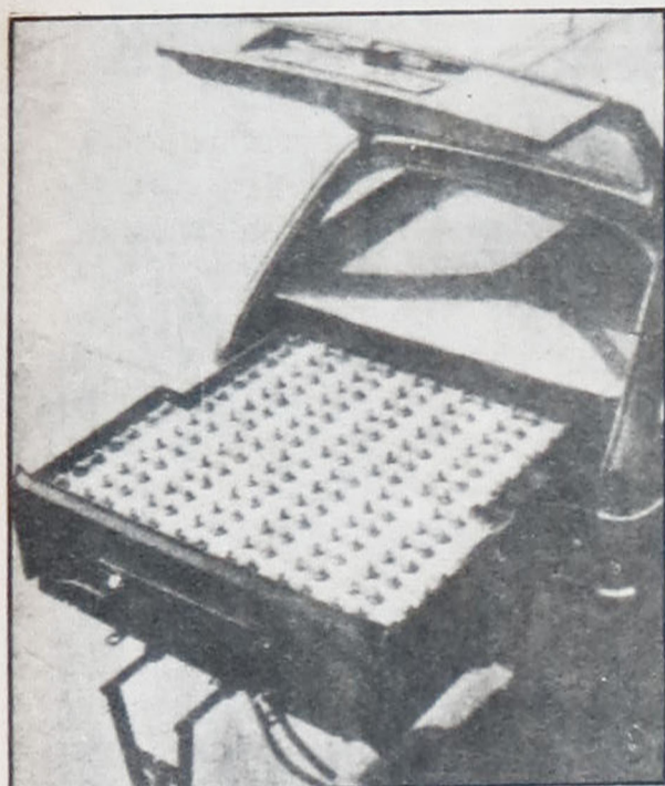
Este carro construído pela firma alemã Daimler tem bateria na parte trazeira.
